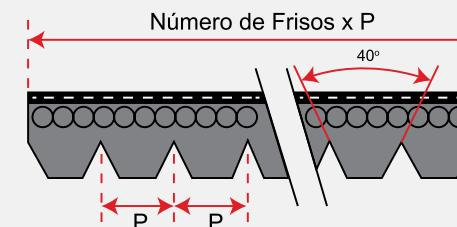
Comprimento Efetivo (Externo) / Norma RMA = Polegadas / Norma ISO = Milímetros
